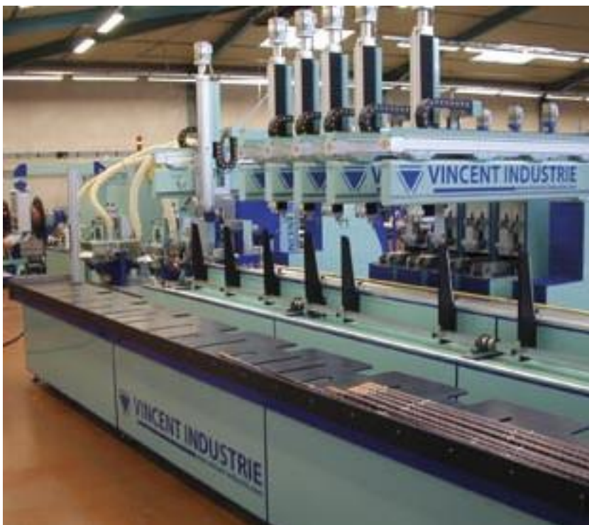
Машина за производство на Roebel-шина на нашия партньор Vincent Industries
